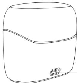
Conexión USB-C para la fuente de alimentación externa
